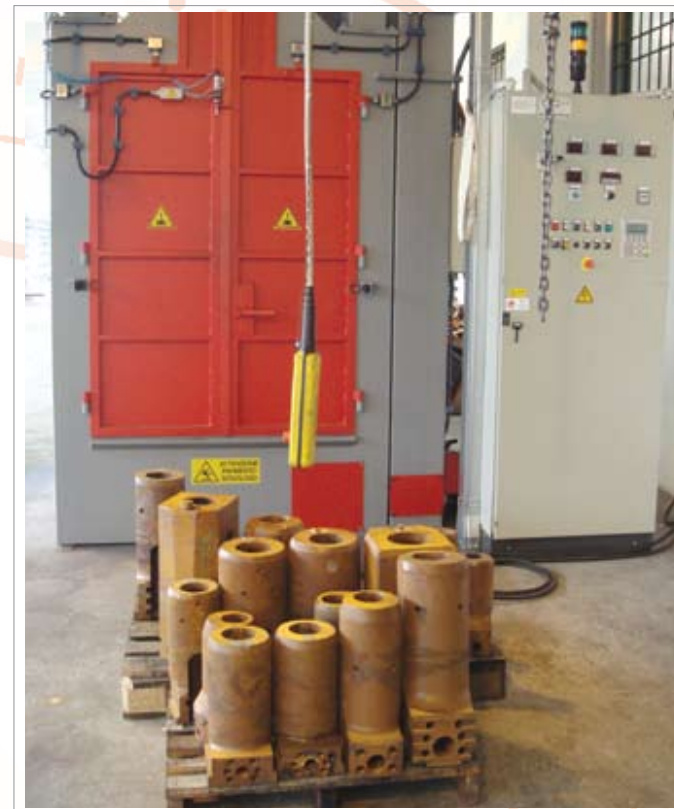
Impianto di sabbiatura Shot blasting unit
